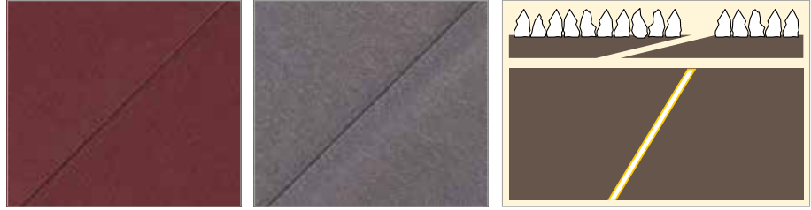
4: Düz Bindirme Yapıřtırma (Üstten Kazımasız)
