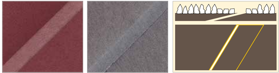
5: Düz Bindirme Yapıřtırma (Üstten Kazımalı)
